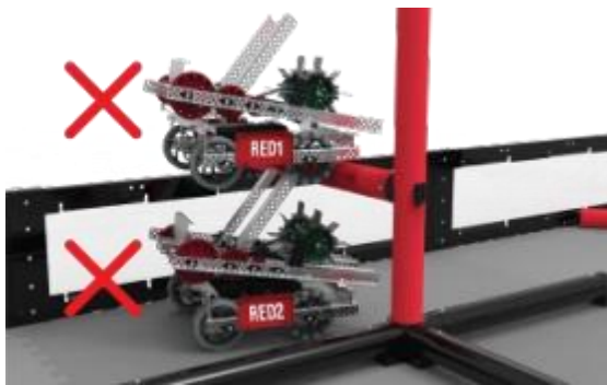
图8 红方机器人1正接触泡沫垫上的红方 机器人2，因此，它们均不视为提升
